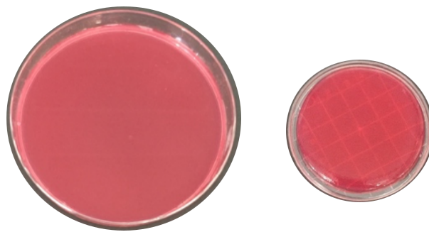
Abbildung 2. Verschiedene verwendete Petrischalen: 120 mm Durchmesser. Quadratisch, Durchm. 90 mm Kreisförmige und Rodac-Platten (von links).
